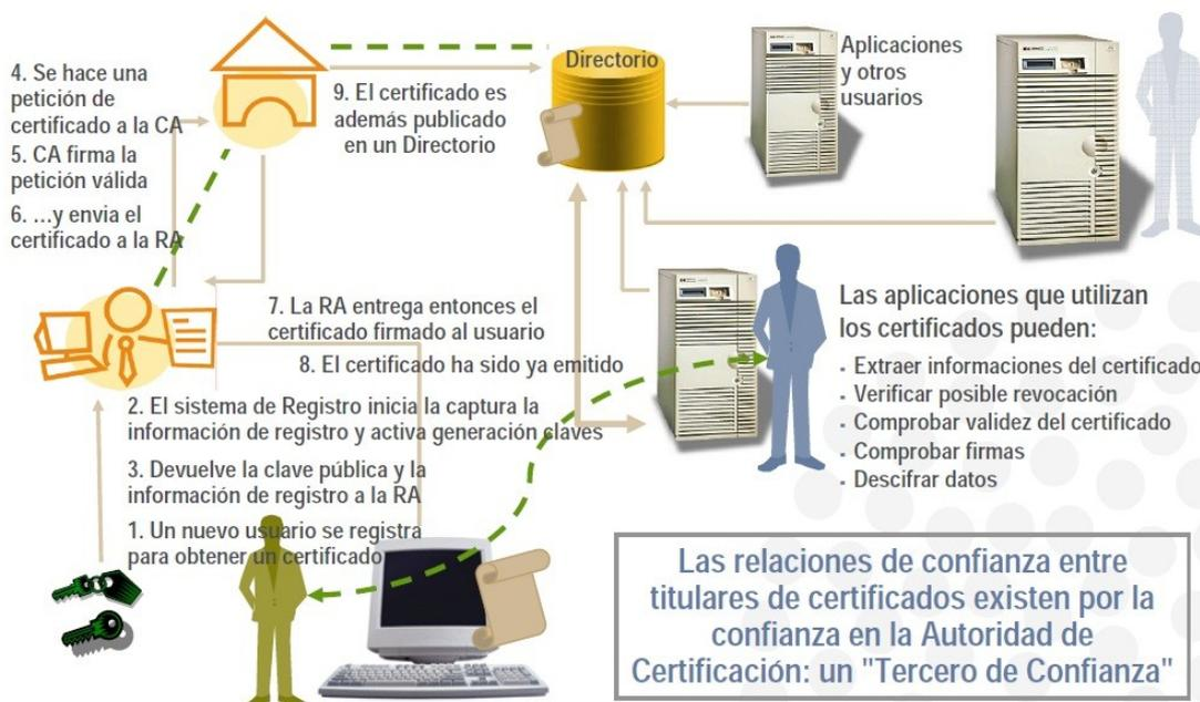
Figura esquemática del funcionamiento de una PKI a alto nivel
